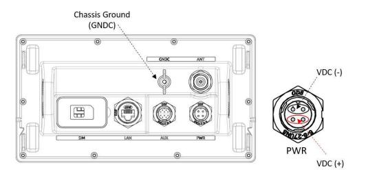
Figure 30: LT-4110 Control Unit (VDC(+), VDC(-), and GNDC)
